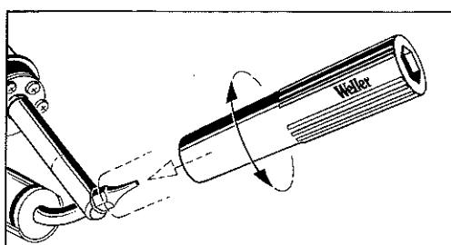
Saugrohr/Suction tube Ø 0,9 für/for DS 112,
