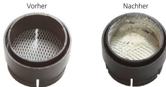
Der Test wurde mit einem bleifreien Lötendraht mit 3 % Flussmittelanteil durchgeführt.
