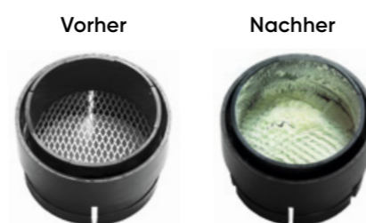
Der Vorher-/Nachher-Effekt auf einem feinen Gitter zeigt das Ausmaß der Verschmutzung nach 90 Minuten
