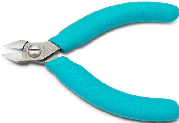
Die Weller Erem Serie 500 Micro ist ein vollständiges Sortiment mittelgroßer, robuster Präzisionsschneider mit einer großen Auswahl an Kopfformen. Die Schneider werden aus hochwertigem Werkzeugstahl hergestellt. Die Schneidkanten sind gehärtet auf Rockwell 63-65 HRc. Die Präzisionsschneider haben eine nicht reflektierende Oberfläche, sind ESD-sicher und können nachgeschärft werden.
