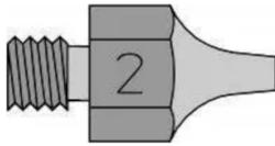
Weller Saugdüsen dienen zum Entfernen von Lötzinn an allen Arten von Lötstellen. Sie werden beheizt und schmelzen das Lot auf. Beim Einschalten des Vakuums am EntlötKolben wird das flüssige Lot durch das in die Düse integrierte Rohr aufgesogen und in den Zinnsammelbehälter geleitet.
