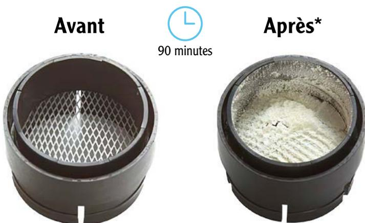
\* La soudure sans plomb produit jusqu'à 250% de particules en plus dans la zone respiratoire que la soudure au plomb. Un filtre propre avant utilisation et avec des polluants après 90 minutes de brasage avec du fil de soudure sans plomb (3% de flux) montre l'efficacité de l'extraction des fumées et l'importance de l'extraction des fumées pendant le brasage. l'efficacité de l'extraction des fumées et l'importance de l'extraction des fumées pendant le brasage.
