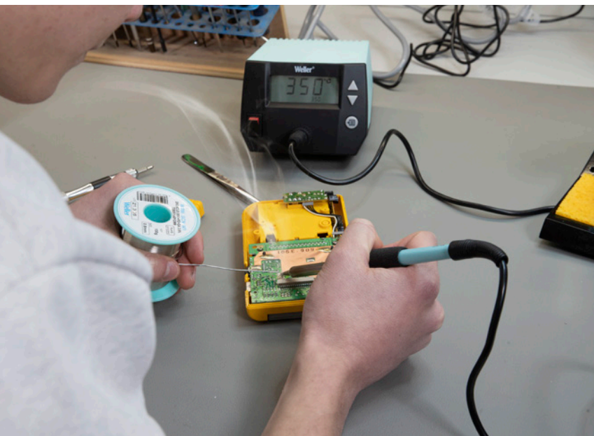
Soudage sans extraction de fumées
