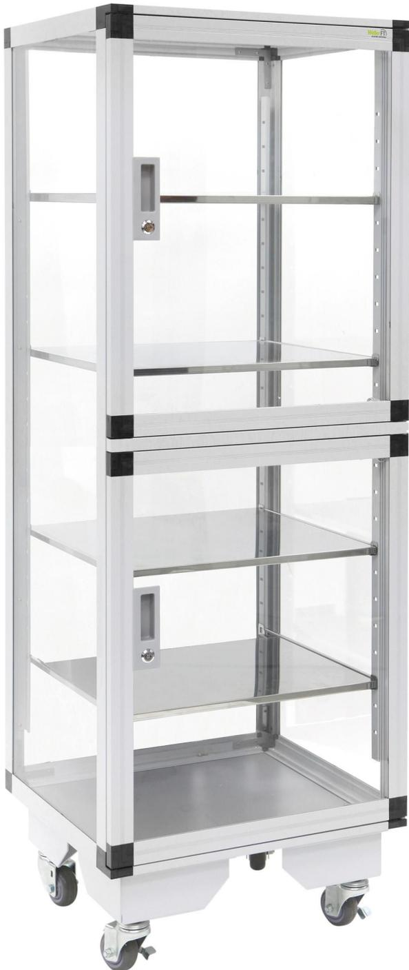
**Les caissons d'aspiration WESDA, protégés contre les ESD, sont spécialement conçus pour le stockage des composants pendant la phase de séchage suivant le collage ou l'enrobage. Les émissions de gaz sont aspirées par un système d'aspiration relié à l'arrière du boîtier par un adaptateur de conduite Easy-Click 60.**
