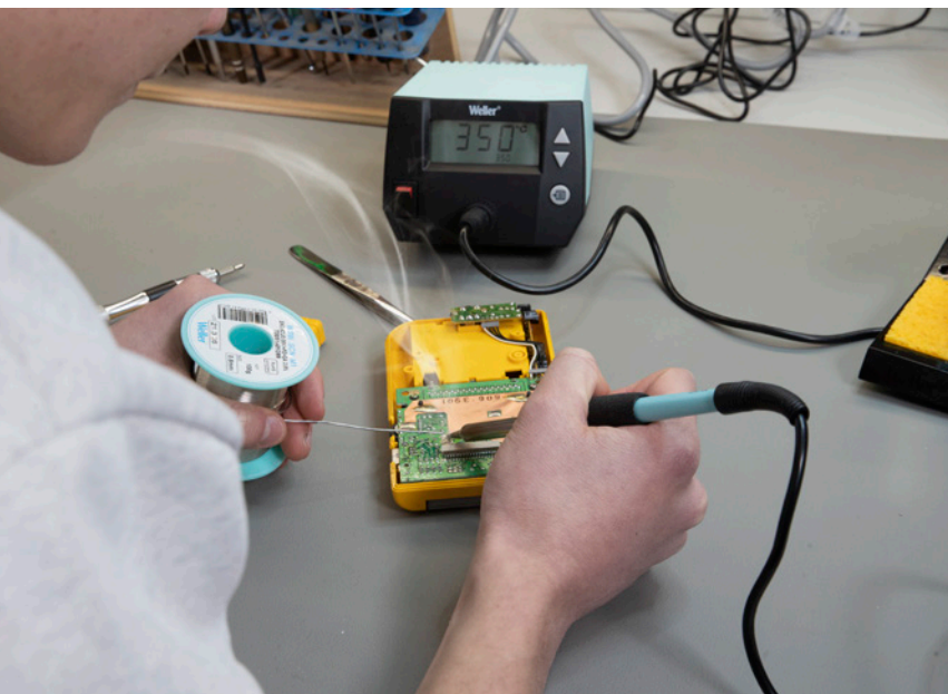
Saldatura senza aspirazione dei fumi
