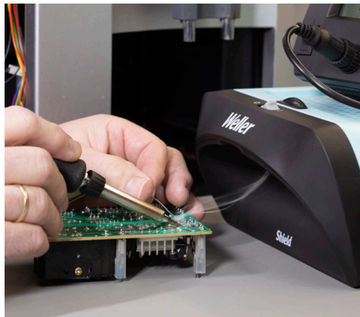
Saldatura con aspirazione dei fumi
