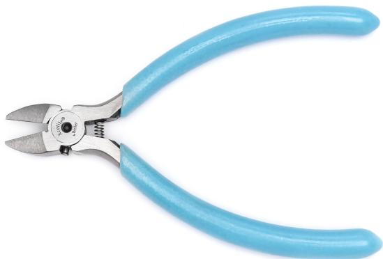
Il tronchesino con testa affusolata Weller® Xcelite® da 4" è ESD-safe e in grado di tagliare fili di rame morbido fino a 22 AWG (0,6 mm).
