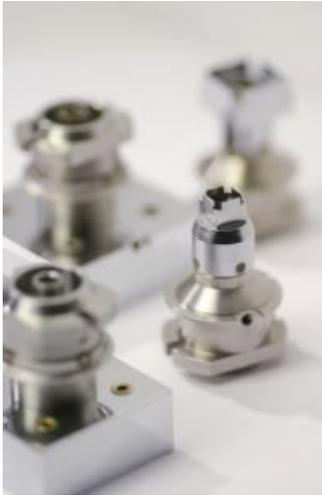
**Ugelli ad aria calda per BGA / QFP 21,0 x 21,0 mm per WQB 4000SOPS, WQB 3000OPS, WQB 3000 Il sistema ugelli brevettato per la stazione di rilavorazione WQB, insieme al controllo digitale della temperatura e del flusso , consentono un adeguato riscaldamento convettivo del componente. E' assicurata una totale ripetibilità dei profili di rifusione.**
