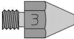
**Ugello con maggiore trasferimento termico. Ø esterno 2,5 mm; Ø interno 1,2 mm; lunghezza 18 mm**
