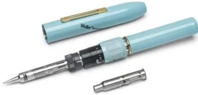
Weller Pyropen Junior è un saldatore a gas butano leggero e ad azionamento manuale con funzioni di saldatura, soffio di aria calda e cannello. Pronto per l'uso in 30 secondi, consente di saldare ovunque, senza bisogno di prese elettriche e senza intralci di cavi. Dispone di coperchio protettivo in alluminio con clip da tasca e una sicura che ne impedisce il montaggio quando il saldatore è in funzione.
