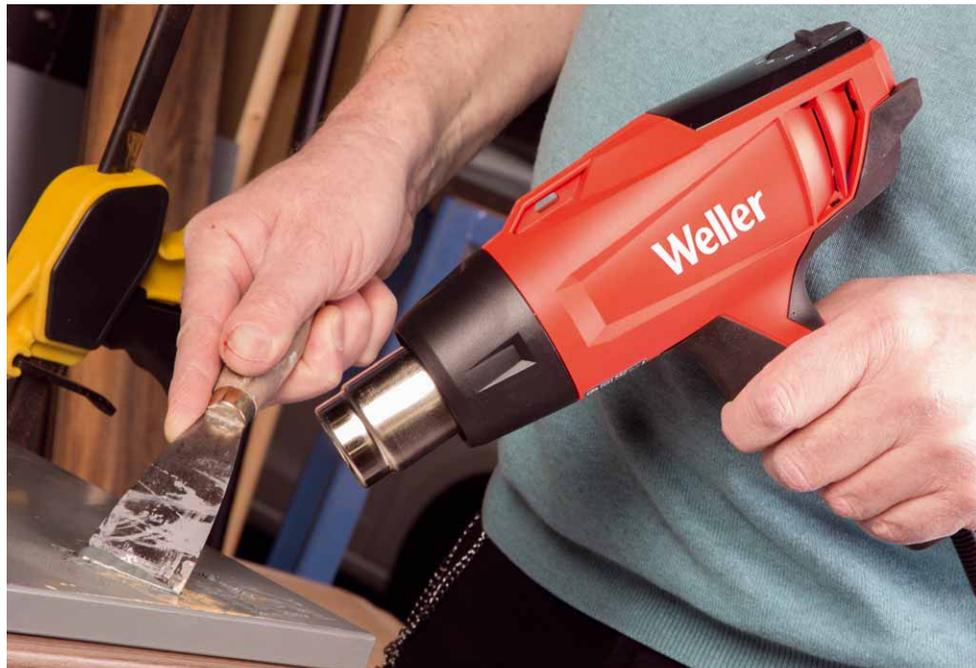
Heissluft-Gebläse werden verwendet um zum Beispiel in der E-Technik Schrumpfschläuche über Leitern oder Verbindungen zu verarbeiten. Maler und Lackierer benutzen diese Geräte um Lack zu erwärmen und dann entfernen zu können und natürlich die bekannteste Anwendung: einen Holzkohlegrill ohne Feuer zu entzünden.
