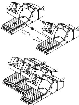
Die Weller WDH 10T/20T Schaltablage bietet, im Gegensatz zur normalen Sicherheitsablage, eine von der Lötplatine auswertbare Schaltfunktion. In der Schaltablage ist ein Mikroschalter integriert, der beim Ablegen und Herausnehmen des Lötkwerkzeuges betätigt wird.
