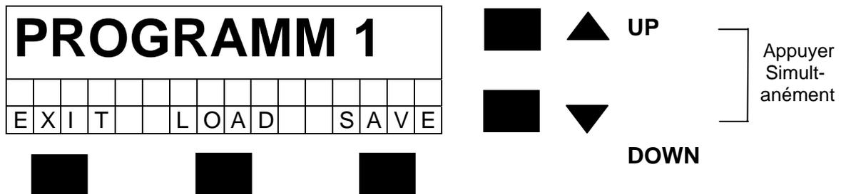
Les programmes s'enregistrent dans les mémoires 1-10 sélectionnées par les boutons UP et DOWN (2/3).
