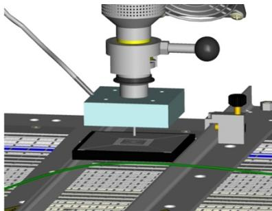
Hierzu wird der Tiefenanschlag des Lötkopfes über die Rändelschraube so eingestellt, dass sich die Düse beim Absetzen ca. 0,5 - 1 mm über der Schablone befindet. Zur genauen Ausrichtung der Schablone wird das Vakuumröhrchen bis zur Schablone abgesenkt und diese genau ausgerichtet.
