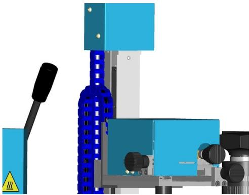
Der Bestückkopf ist mit einem Schrittmotor versehen, welcher ein präzises, softwaregesteuertes Absetzen und Aufnehmen der Bauteile ermöglicht. Die Bauteilaufnahme mit dem Bestückkopf (11) erfolgt mit der Vakuumdüse (29). Zum Abheben von Bauteilen wird das Vakuum über "Vacuum" aktiviert. Beim Absetzen kann mit dem zusätzlichen Automatik-Modus das Bauteil voll automatisch platziert werden.
