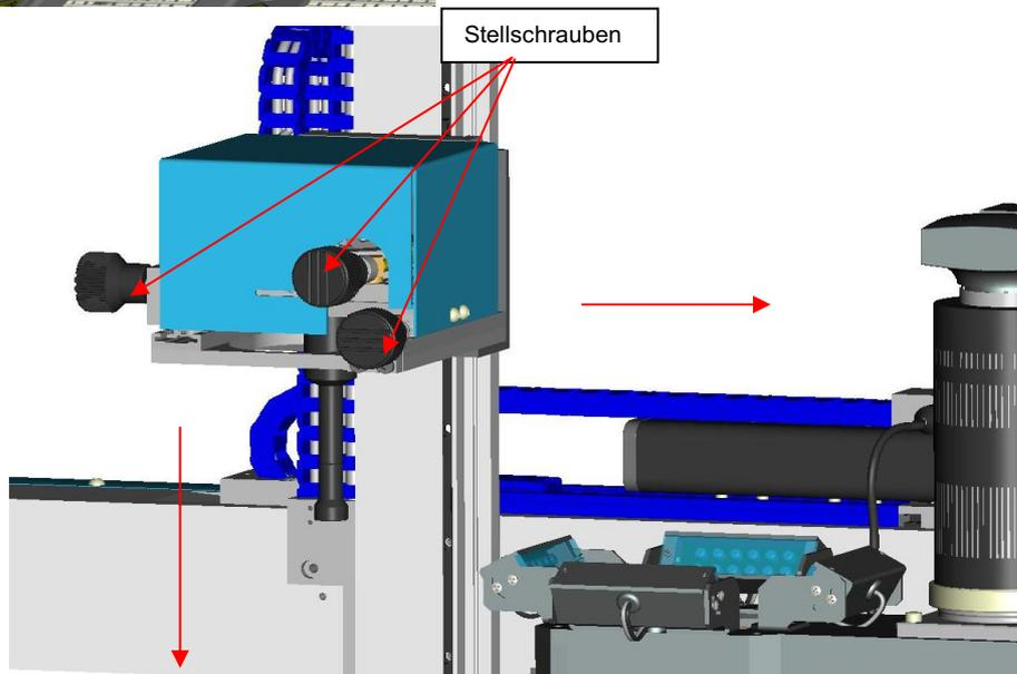
Abheben des Lötkopfes zur Freigabe des Transporttisches. Anschließend den Tisch in "Placement Pos." fahren.
