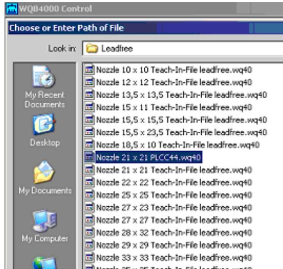
**Durch Laden eines Parametersatzes und Abspeichern unter einem anderen Namen, können geänderte / eigene Parametersätze erstellt werden!**
