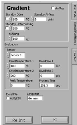
Mit dem Gradientenmodus ist es möglich gezielte Aufheizgradienten und sogar ein gezieltes Abkühlen zu ermöglichen. Hierzu wird für jeden Prozessschritt ein maximaler Gradient vorgegeben.
