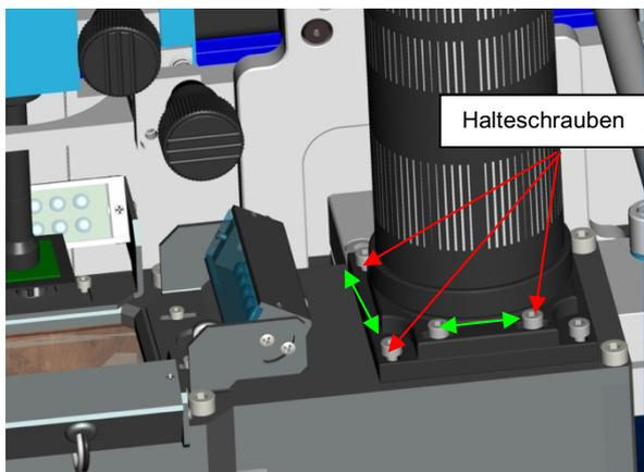
Die Ausrichtung der Kamera auf die Bildmitte erfolgt ab Werk und muss durch Einblenden des Fadenkreuzes über Crossing „Show / Hide“ oder des Rechteckrahmens mit Frame „Show / Hide“ überprüft werden (siehe Kapitel 7.3.1.3). Im Falle von Abweichungen kann diese mit Hilfe der verstellbaren Kamerahalterung nachjustiert werden. Hierzu sind die Befestigungsschrauben der jeweiligen Kamerahalterungsebene zu lösen, die Kamerahalterung ist neu auszurichten und wieder zu arretieren.
