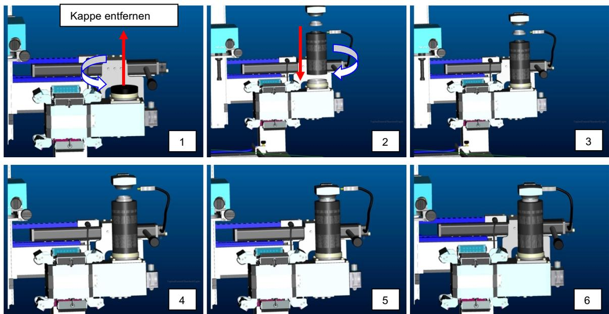
Zur Installation des 10 x Zoom Objektivs ist die Abdeckkappe auf dem Optikgehäuse zu entfernen. Anschließend wird das Zoom Objektiv wie in den obigen Abbildungen montiert.
