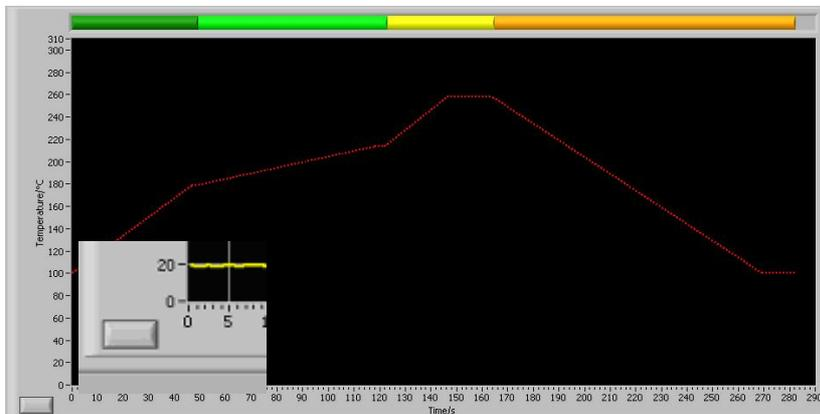
Zur besseren Verdeutlichung des Profils wird dieses mit einer gestrichelten roten Linie im Chart dargestellt. Wird ein Parameter geändert, wird das Profil entsprechend angepasst.
