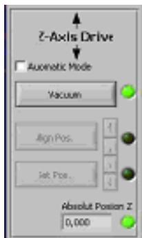
Im Automatic Mode stehen dem Anwender automatisierte und teilweise vereinfachte Funktionen zur Verfügung. Die Positioniereinheit kann zum Ausrichten des Bauteils mit „^“ angehoben und „V“ abgesenkt werden. Das Bauteil wird mit „Set Pos.“ auf die Leiterplatte abgesetzt. Das Vakuum wird automatisch abgeschaltet und die Positioniereinheit abgehoben.
