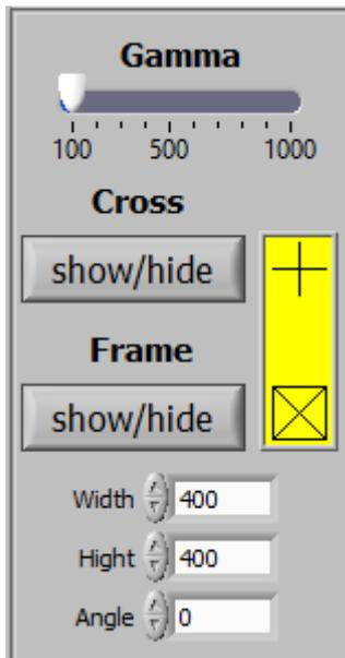
Über diese Schaltfläche kann der Benutzer für die jeweiligen Anforderungen eine optimierte Bildkonfiguration einstellen, und mit den Schaltflächen Crossing „Show / Hide“ oder Frame „Show / Hide“ wird zur einfacheren Ausrichtung von Bauteilen ein Fadenkreuz oder ein Rechteck eingeblendet. Größe und Ausrichtung des Rechtecks lassen sich über „Width“, „Hight“ und „Angle“ verändern.
