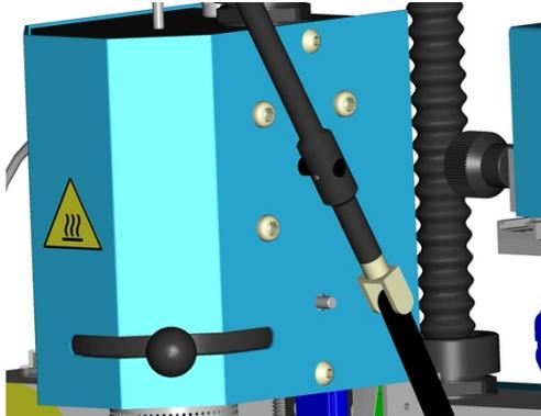
Der Lötkopf ist mit einem rotationsgedämpften Gelenkhebel (16) versehen. Durch die Betätigung des entsprechenden Gelenkhebels kann der Lötkopf erschütterungsfrei abgehoben oder abgesenkt werden. Zusätzlich kann ein Bauteil beim Entlötvorgang mit dem Vakuumrohr, bei abgesenktem Lötkopf, abgehoben werden.
