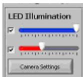
Die Platinen- oder Bauteilbeleuchtung kann hierüber Ein- bzw. Ausgeschaltet und gedimmt werden.
