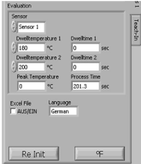
Mit Hilfe des Re Init Buttons ist es möglich die Kommunikation zwischen PC und WQB 4000SOPS ohne Softwareneustart zu Reinitialisieren. Unterbrochene Prozesse müssen NEU gestartet werden.
