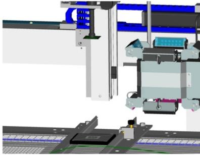
Nach dem Abheben darf weder der Tisch in x-, y- noch die Positioniereinheit in x-, y-, Teta- Richtung verändert werden. Die Split-Optik auf Linksanschlag bis zum Einrasten zwischen Justierbauteil und Justierschablone fahren und mit der Positionierungssoftware die Platinenbeleuchtung aktivieren. Auf dem Monitor ist die Justierschablone in rot zu erkennen. Über die Stellringe für Blende und Schärfe wird eine optimale Darstellung der Schablone erzielt.
