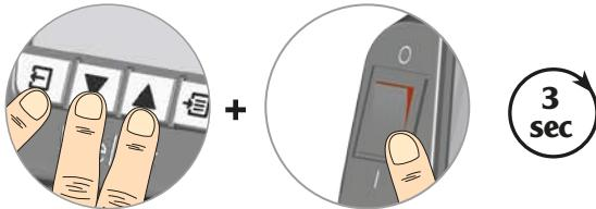
Lors de la mise sous tension : Appuyer sur les touches Exit, UP et DOWN pendant 3 secondes
