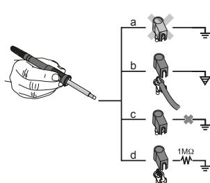
3.5 mm のジャックソケットを異なる接続方法で接続することで、4 種類の使用方法が可能となります:
