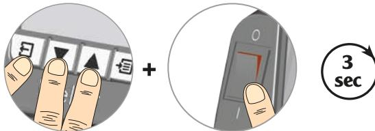
Vid påslagning: Håll Exit, UP och DOWN intryckta i 3 sekunder
