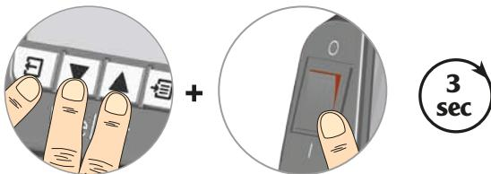
Sisselülitamisel: vajutage Exit, UP ja DOWN 3 sekundit
