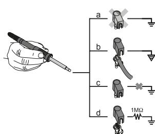
Durch unterschiedliche Schaltung der 3,5 mm Schaltklinkenbuchse sind 4 Varianten möglich:
