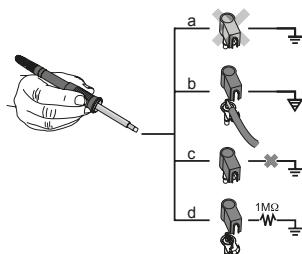
Door verschillende beschakeling van de 3,5 mm schakelstekkerbus zijn er 4 varianten mogelijk:
