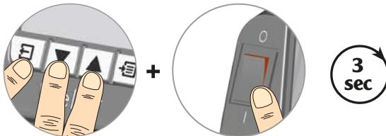
スイッチオン時: Exit、UP および DOWN を 3 秒押します
